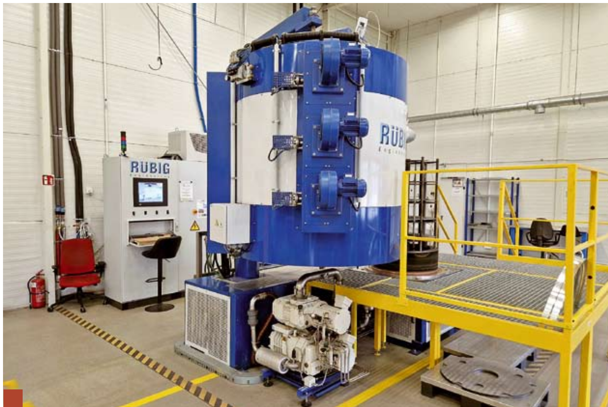
W Wuzetem zainwestowano w ciąg technologiczny marki Rubig. Procesy mycia są bardzo istotne, nim nastąpi załadunek wsadu do komory pracującej w technologii PACVD (Plasma Assisted CVD). Testy laboratoryjne wybranych próbek obejmują identyfikowanie zarysowań oraz badania twardości i symulację warunków pracy wtryskiwacza
