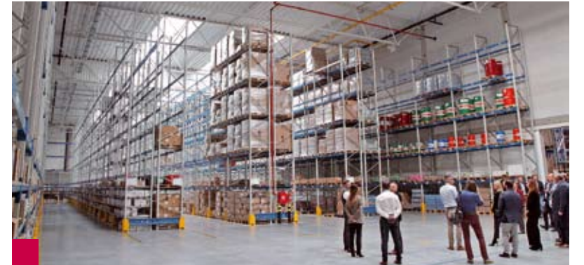
Całkowita powierzchnia systemu regałów wielopoziomowych wynosi ok. 14 100 m 2 . Nie licząc poziomu podłogi, każdy z 3 poziomów ma ok. 4700 m 2 . Aby zapewnić maksymalne bezpieczeństwo, w magazynie jest również wyizolowany obszar do przechowywania produktów ADR (towarów niebezpiecznych). Są one bezpiecznie składowane w bunkrze o powierzchni 1845 m 2
