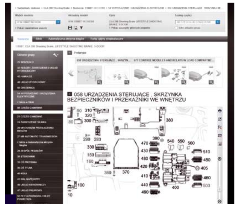
Rysunek z dokumentacji EPC – grupa konstrukcyjna 54 – układ elektryczny. Podgrupa 058 – urządzenia sterujące, skrzynka bezpieczników wraz z przełącznikami
