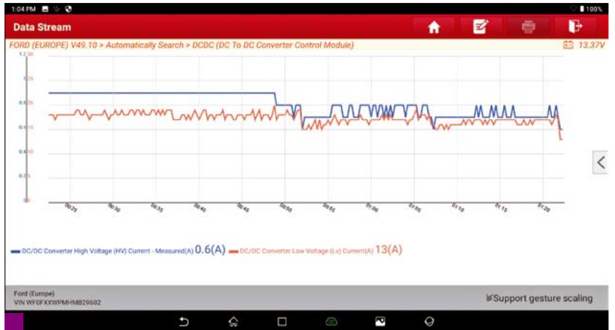
Wykres pracy konwertera DC/DC, czyli urządzenia przekształcającego jedno napięcie stałe na drugie o innej wartości
