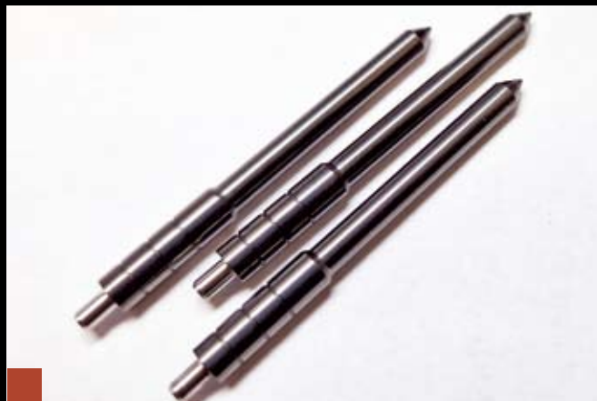
Z sukcesem nałożone powłoki typu Diamond-Like Carbon zapewniają trwałość nawet kilkukrotnie większą od igieł niepowleczonych. Ponadto takie ultracienkie warstwy gwarantują małe opory ruchu i znakomitą odporność korozyjną
