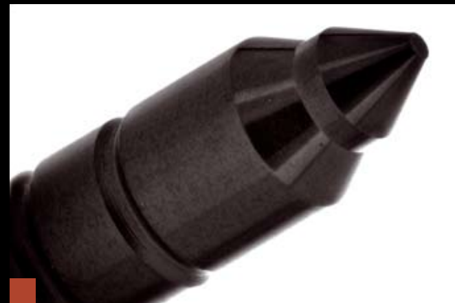
Widok mikroskopowy stożka igły rozpylacza z powłoką DLC
